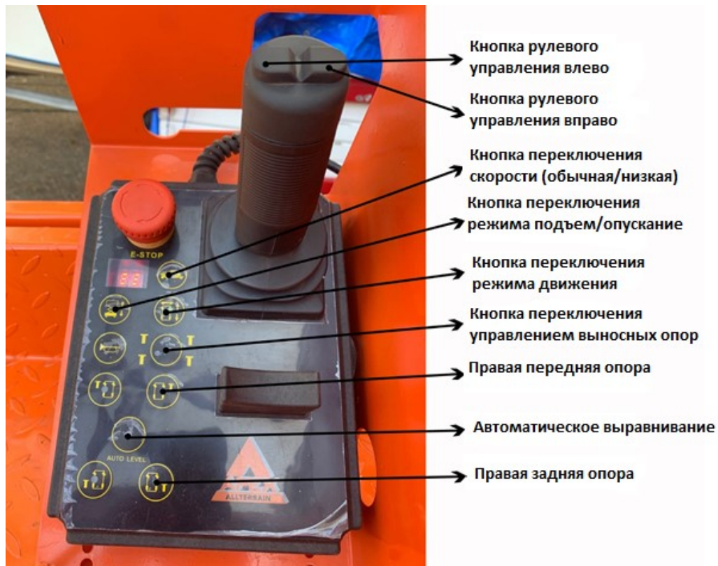
Рис.3 - Контроллер платформы подъемника гусеничного ножничного типа с автоматическими выдвигаемыми опорами
